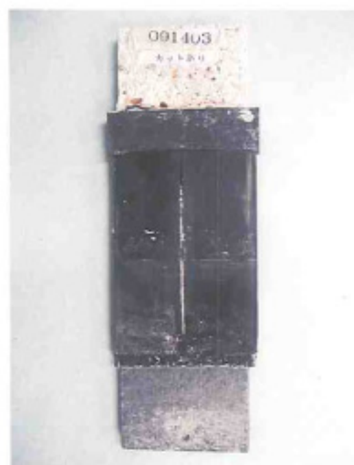
写真6 モルタル破壊後の試験体(カットあり)
