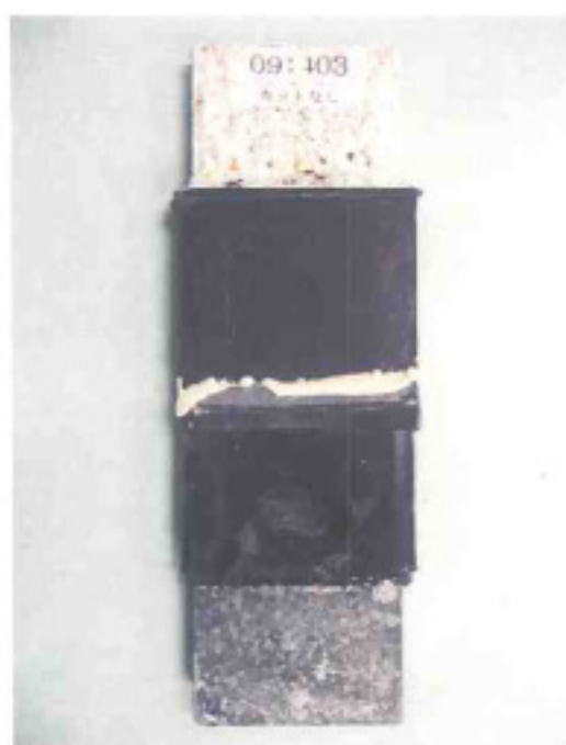
写真5 モルタル破壊後の試験体(カットなし)
